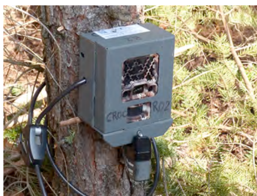
Figure 11 : Modèle de piège photographique Reconyx HC600 avec flash infrarouge invisible utilisé pour le suivi ponctuel du Lynx mis en place en 2014 dans les Vosges du Nord (© CROC).
