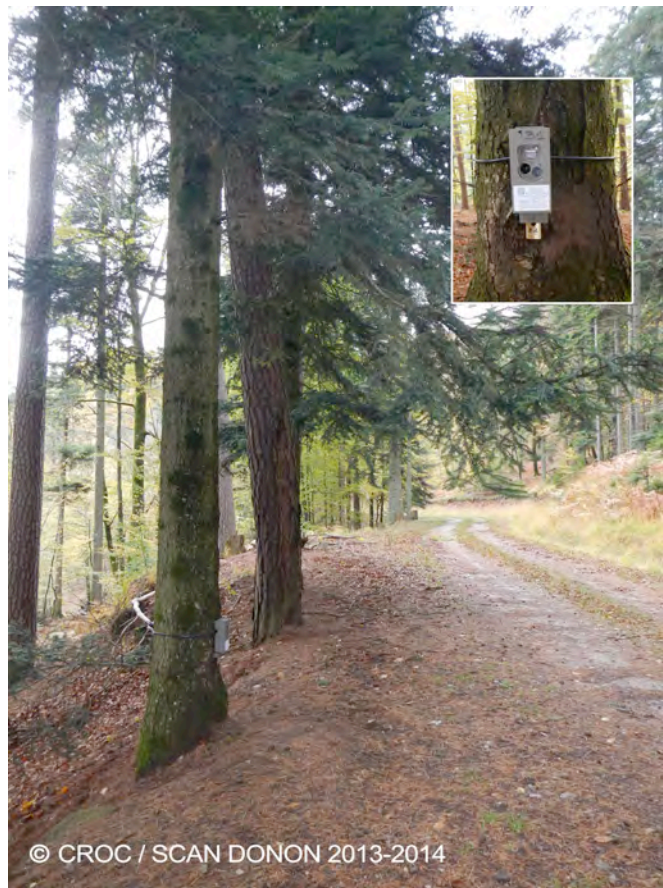
Figure 7 : Illustration de la hauteur (30-50 cm du sol) et de la distance à laquelle les pièges photographiques de type Cuddeback Ambush sont posés par rapport aux allées forestières. On distingue le caisson métallique sur lequel une affichette d'information est collée. Ce caisson métallique est fixé à l'arbre avec un câble Python (câble noir). Le piège photographique est enfermé dans le caisson métallique avec un cadenas à anse protégée (© CROC).
