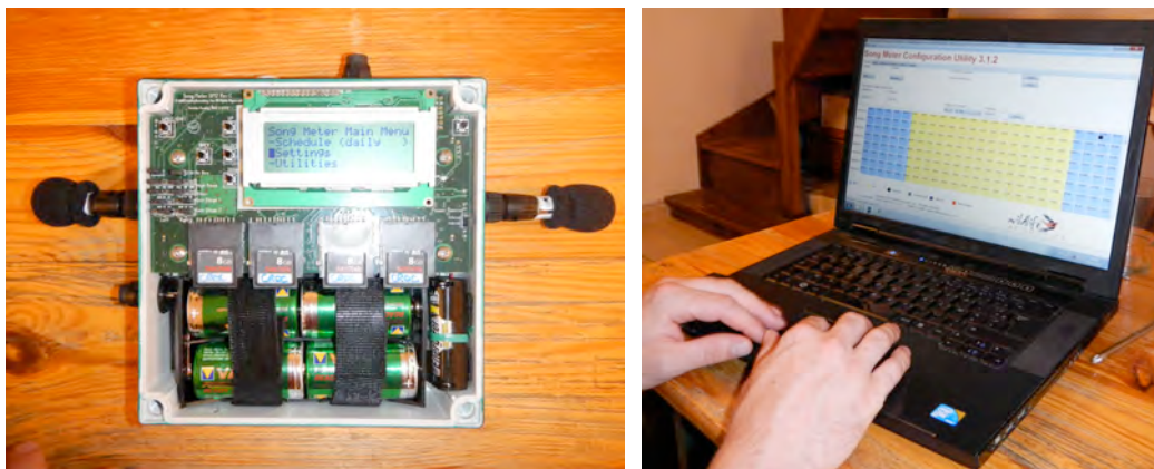
Figure 16 : Illustration d'un enregistreur autonome (SM2) et du paramétrage des cartes mémoires avant la pose sur le terrain (© CROC).
