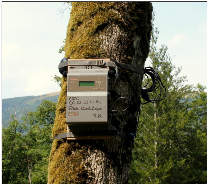
Figure 4 : Enregistreur autonome de type SM3 élaboré par Wildlife Acoustics (© CROC 2015)
